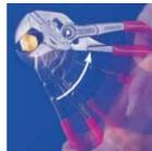
Храповик само-настраивается на размер головки болта без предварительной установки
