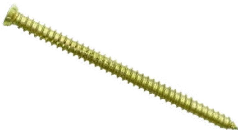
Сталь холоднокатаная и холодно-прессованная DIN 1654 с гальваническим цинковым покрытием толщиной минимум 8 мкм, жёлтого цвета. Шуруп имеет переменную резьбу (высокая/низкая) и спиралевидные проточки по всей длине резьбы, которые облегчают вкручивание шурупа. Насечки на головке предотвращают самопроизвольное выкручивание.
