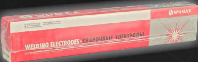
Предназначены для сварки корневого шва поворотных и неповоротных стыков трубопроводов класса прочности до K60 включительно (с нормативным временным сопротивлением разрыву до 588 МПа включительно), а также для сварки всех слоев шва трубопроводов класса прочности до K54 включительно (с нормативным пределом прочности до 539 МПа).
