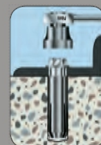
Установите деталь с необходимым моментом затяжки
